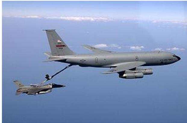
Lorsqu'il est ravitaillé en vol, un avion de chasse ne s'arrête pas (sinon, il tombe !). Et pourtant, il doit être fixe par rapport au ravitailleur.
